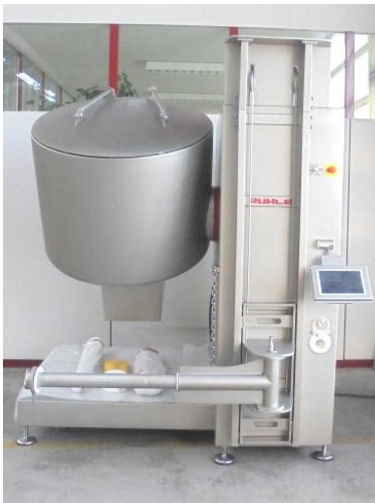
Рисунок 1 Современная вакуумная фаршемешалка фирмы Rühle (Германия)
